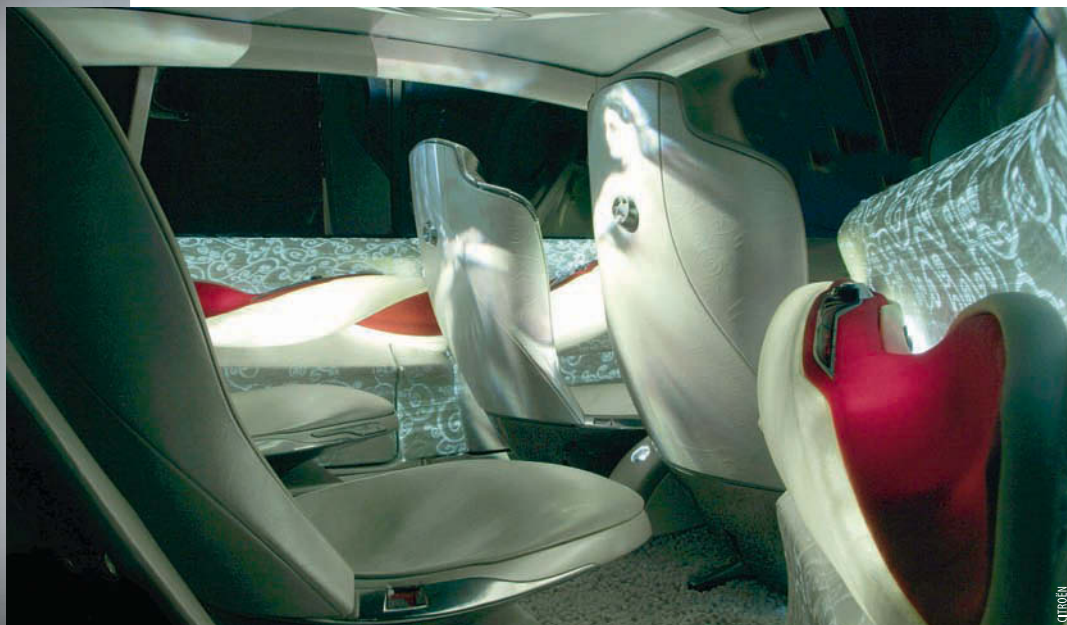
Dans le C-AirLounge, projet développé par Brochier pour Citroën en 2003, le décor des garnitures de portières et de sièges se transforme grâce à des fibres optiques
